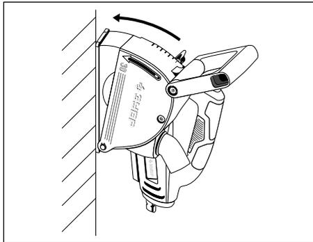
Установите изделие (в начале линии пропила) роликом 9 на обрабатываемую поверхность так, чтобы диски не касались поверхности. Плавно наклоняйте изделие, углубляясь дисками в поверхность до нужной глубины реза или до упора ограничителя.
